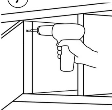
Die Klebepunkte sind nur eine Montagehilfe. Sie halten die Tür nicht auf Dauer. Daher muss die Tür zusätzlich mit 3 Schrauben fixiert werden.
