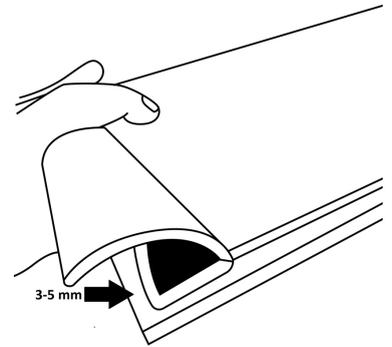
Lege das Cover auf die bedruckte Sichtseite und klebe die Spannlippe auf die abgesenkte Fläche. Wichtig: Die Spannlippe muss so nah wie möglich an die Innenseite, also gegen die Kante der Absenkung geklebt werden. Wie im Bild zu sehen, bleibt zwischen Außenkante des Covers und Spannlippe ein freier Bereich von 3-5mm.
