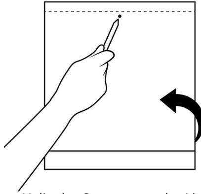
Halte das Cover gegen das Licht. Nun kannst du das vorgestanzte Loch für die Griffschraube durchschimmern sehen. Steche mit einem spitzen Gegenstand durch das Loch, wende das Cover und steche erneut hindurch.
