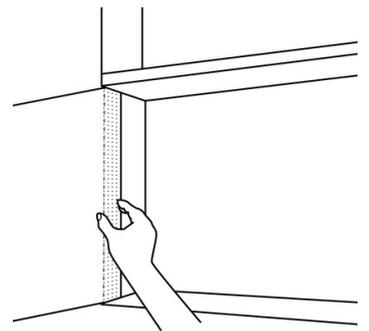
Nun kannst du die Schutzfolie der beiden Klebepunkte entfernen und die Tür einkleben. Das Ende des Scharniers sollte auf den zuvor angezeichneten Strichen liegen.
